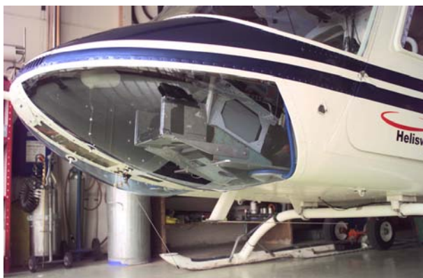
Рис. 60. Размещение аэросъемочного комплекса на вертолете Bell-206 Jet Ranger с внутренней установкой сканерного блока.
