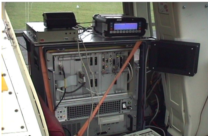
Рис. 57. Размещение стойки управления локатора, GPS приемника и вспомогательного оборудования.
