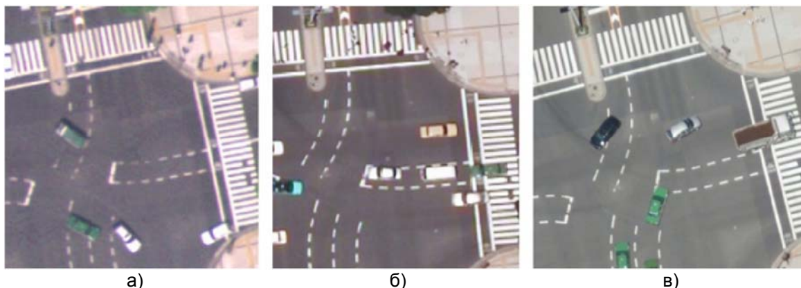
Рис. 139. Сравнение результатов съемки различными системами: а) снимок сделан цифровым АФА Leica ADS-40 (разрешение 20 см); б) снимок сделан цифровым АФА Vexcel UltraCAM-D (разрешение 20 см); в) снимок сделан цифровым АФА Vexcel UltraCAM-D (разрешение 8 см. В данном случае, такое качество практически не достижимо для ADS-40).
