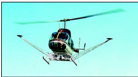
Рис. 34. Аэросъемочный комплекс FLI-MAP компании FUGRO с двумя разнесенными GPS антеннами.
