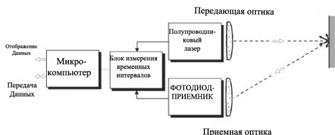
Рис. 152. Схема работы лазерного дальномера.
