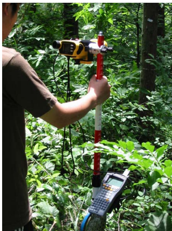
Рис. 70. Измерение и регистрация таксационных и морфоструктурных параметров деревьев на пробной площади лазерным дендрометром Laser Ace 300, сопряженным с полевым компьютером Psion.
