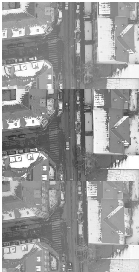
Рис. 127. Крупномасштабная аэрофотосъемка объектов многоэтажной застройки с продольным перекрытием 80-90%.
