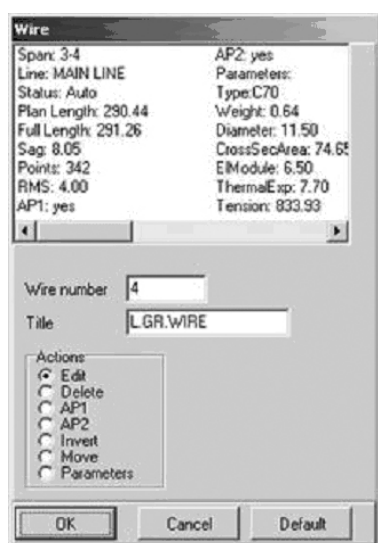
Рис. 111. Окно параметров пространственного положения провода и его свойств.
