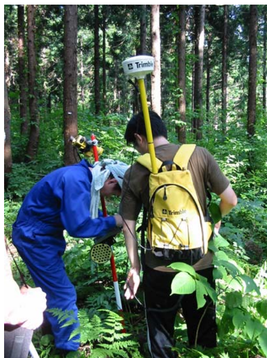
Рис. 71. Определение местоположения и географических координат на пробной площади лазерного трансекта системой спутникового позиционирования DGPS Trimble ProXR.
