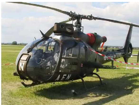
Рис. 58. Размещение аэросъемочного комплекса на вертолете Gazelle.
