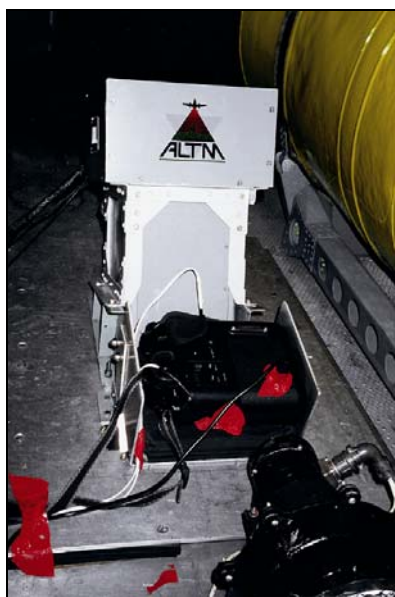
Рис. 31. Совместное использование аэросъемочного лидара ALTM и цифрового аэрофотоаппарата.
