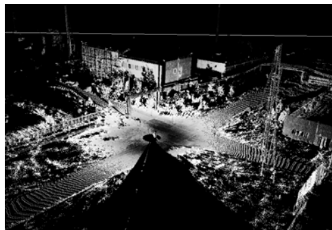
Рис. 4. Типовое лазерно-локационное изображение в дальномерной форме, полученное методом наземного лазерного сканирования.
