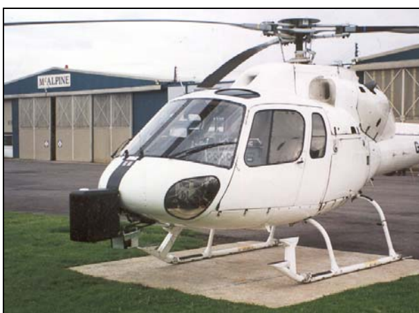
Рис. 61. Размещение аэросъемочного комплекса на вертолете Eurocopter AS-350.
