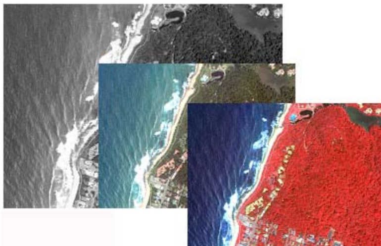
Рис. 126. Возможность получения панхроматических, цветных и спектрональных аэрофотоснимков.
