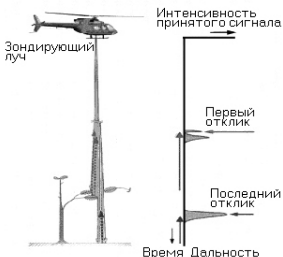
Рис. 13. Регистрация множественных отраженных импульсов в одном акте сканирования.
